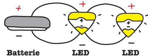
Dabei entstehen mehrere Schleifen, denen der Strom folgen kann, wodurch alle LEDs gleichzeitig mit nur einer Batterie angeschaltet werden.
