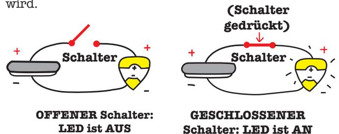
Wenn der Schalter geschlossen ist, geht das Licht an, weil die Schleife durchgehend ist und die Elektronen durch den Schaltkreis fließen können. Wenn der Schalter offen ist, können die Elektronen keine durchgehende Schleife finden. Darum hören sie auf zu fließen, und das Licht geht aus.
