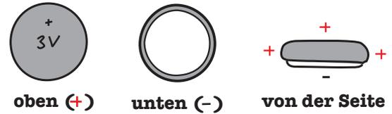
Eine Batterie versorgt deinen Schaltkreis mit Energie. Die obere Seite ist mit einem „+“ markiert und die Außenseiten der Batterie sind ebenfalls positiv. Die Unterseite ist negativ. Wenn leitfähiges Material die Batterie einfach nur berührt, dann entsteht eine elektrische Verbindung.
