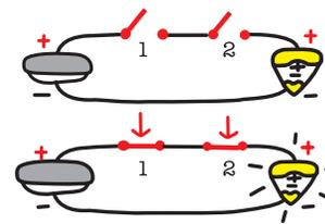
Wenn du mehrere Schalter in eine einzelne Schleife einbaust („in Serie“), dann müssen alle Schalter gleichzeitig gedrückt werden, um dein Licht anzuschalten. Das wird logisches **UND** genannt, weil du *Schalter 1 und Schalter 2* drücken musst, um einen geschlossenen Schaltkreis herzustellen.
