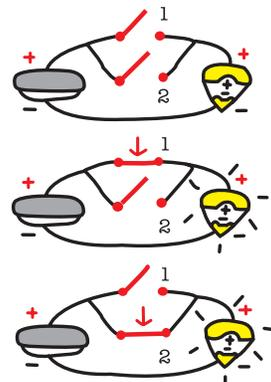
Du kannst auch mehrere Schalter in verschiedenen Zweigen schalten („parallel“). Es reicht dann aus, irgendeinen Schalter zu drücken, um das Licht anzuschalten. Das wird logisches **ODER** genannt, weil du *Schalter 1 oder Schalter 2* drücken kannst, um einen geschlossenen Schaltkreis herzustellen.
