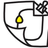
Du kannst mit der leitfähigen Kunststofffolie einen Krümmungssensor bauen. Mache einfach einen langen Schalter und platziere die Kunststofffolie zwischen die Lücke und den Kontakt. Wenn du den Sensor biegst, wird das Licht heller leuchten!
