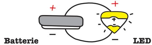
Elektronen fließen nur in Schleifen, und so ein geschlossener Schaltkreis ermöglicht den Elektronen, von der Batterie durch die LED und wieder zurück in die Batterie zu fließen. Dieser Rundumfluss von Elektronen, **auch Strom genannt**, macht, dass das Licht angeht und leuchtet.
