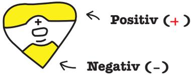
LED steht für **licht-emittierende Diode**. LEDs leuchten, wenn sie mit Energie versorgt werden. Der LED-Sticker hat die Form eines Pfeils, der von „+“ nach „-“ zeigt. Das breite, flache Metallplättchen ist das „+“-Ende und das spitze Metallplättchen ist das „-“-Ende.
