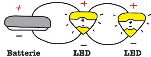
Dabei entstehen mehrere Schleifen, denen der Strom folgen kann, wodurch alle LEDs gleichzeitig mit nur einer Batterie angeschaltet werden.
