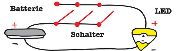
Wenn du hier drückst und deinen Finger entlang des Schalters schiebst, öffnet und schließt sich die Lücke mehrmals und das Licht geht dadurch an und aus: Es blinkt!
