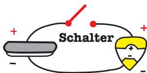
OFFENER Schalter: LED ist AUS
