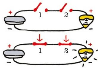
Si colocas varios interruptores en un circuito simple ("en serie"), debes presionar ambos a la vez para encender tu luz. Esto se conoce como operador lógico **Y** (AND) porque tienes que apretar el Interruptor 1 **y** el Interruptor 2 para cerrar el circuito.
