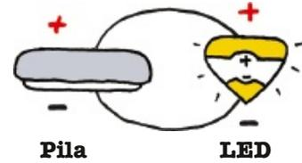
Los electrones sólo se desplazan en circuitos cerrados y este circuito completo les permite ir de la pila al LED y de vuelta a la pila. Este viaje de ida y vuelta, llamado **corriente**, hace que el LED se encienda y se ilumine.
