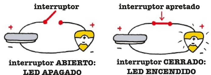
Cuando el interruptor está **cerrado** la luz se enciende porque el círculo se completa y los electrones pueden fluir a través del circuito. Cuando el interruptor está **abierto**, los electrones no encuentran el círculo cerrado, por lo que dejan de fluir y la luz se apaga.
