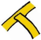
Para conectar dos tiras de cobre, pega una sobre la otra y presionala firmemente para que el adhesivo conductor haga buen contacto. Para conexiones más permanentes, puedes soldar ambas tiras juntas.
