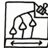
Intenta conectar distintas ramificaciones de LEDs con un solo interruptor deslizable.
