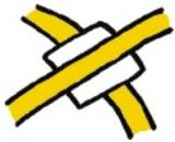
Si quieres que dos piezas de cobre se crucen sin hacer conexión, simplemente coloca una pieza de papel entre ambas.
