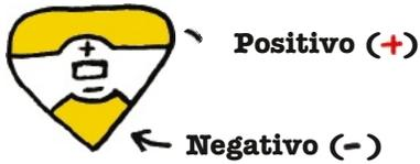
Los **diodos emisores de luz**, LEDs, se iluminan al suministrarles energía. El adhesivo LED tiene la forma de una flecha señalando del "+" al "-". La base de metal ancha y horizontal es el extremo "+" y la base de metal en punta es el extremo "-".
