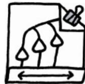
试着在一个划动开关上连接多个LED灯。
