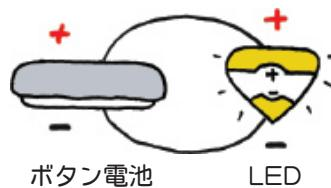
電子はつながった輪の中を循環します。この完全な回路によって、電子が電池からLEDを通り、また電池に戻ってきます。この電子の流れを電流と呼び、光を点灯させて輝かせることができます。
