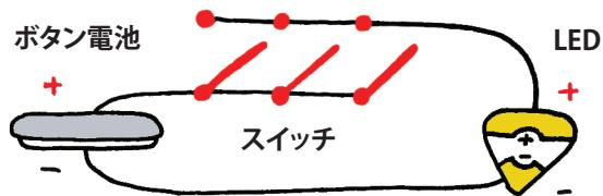
スイッチに沿つて指を滑らせると、回路の隙間が開いたり閉じたりして、光が点灯したり消灯したりします。
