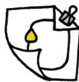
導電性のあるプラスチックを使って、曲げセンサーを作ることができます。長いスイッチを作り、その間にプラスチックを挟んでみましょう。センサーを曲げると、光がより明るく輝きます。
