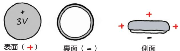
電池は回路に電力を供給します。「+」印がある表面と側面は正極（+極）で、裏面は負極（-極）です。導電性のある素材を電池に触れさせると、通電します。
