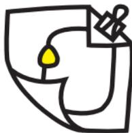
Du kannst mit der leitfähigen Kunststofffolie einen Krümmungssensor bauen. Mache einfach einen langen Schalter und platziere die Kunststofffolie zwischen die Lücke und den Kontakt. Wenn du den Sensor biegest, wird das Licht heller leuchten!
