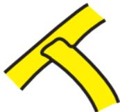
Um zwei Stücke der Kupferfolie zu verbinden, klebe ein Stück über das andere und drücke das Klebeband fest an, damit der leitfähige Klebstoff einen guten Kontakt herstellt. Für dauerhaftere Verbindungen kannst du die Kupferklebebandteile auch zusammenlöten.
