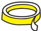
Kupferklebeband besteht aus dem Metall Kupfer und ist darum ein sehr guter elektrischer Leiter. Es lässt sich auch genauso löten wie Metalldraht, und der Kleber auf der Rückseite ist teilweise leitfähig.
