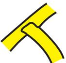
Pour connecter deux morceaux de bande de cuivre, colle une bande sur l'autre et appuies fermement pour que l'adhésif conducteur ait un bon contact. Pour une connexion plus permanente, tu peux aussi utiliser un fer à souder pour bien les connecter ensemble.
