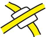
Si tu veux que deux morceaux de cuivre se traversent sans se connecter, il suffit de placer un morceau de papier entre les deux bandes de cuivre.
