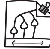
Prova a connettere differenti rami di LED lungo un unico interruttore a scorrimento lampeggiante.
